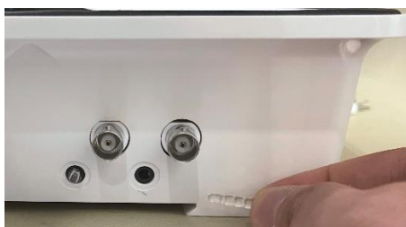
Enlever les 2 caches de protection des prises Jack
