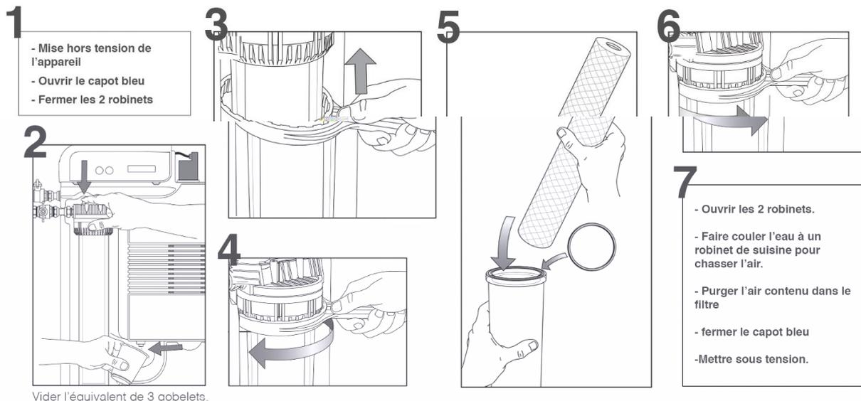
Appuyer sur la purge du filtre et vider l'équivalent de 3 verres d'eau
